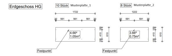
Beispiel DXF-Datei Inhalt mit Bohrungen: Musterplatte\_1.dxf
